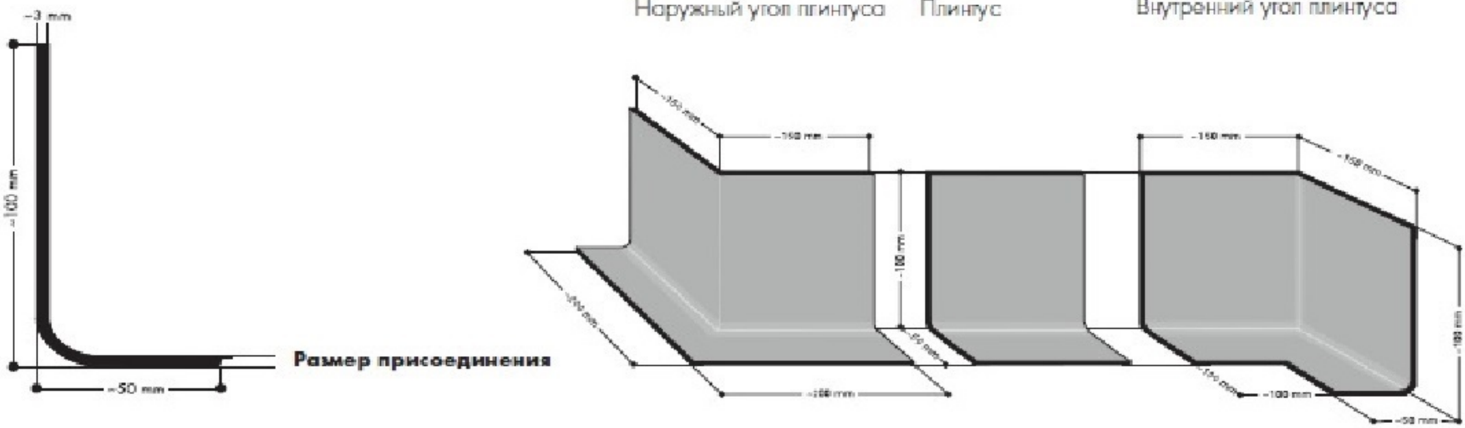
1 Наружный угол плинтуса 2 Плинтус 3 Внутренний угол плинтуса
